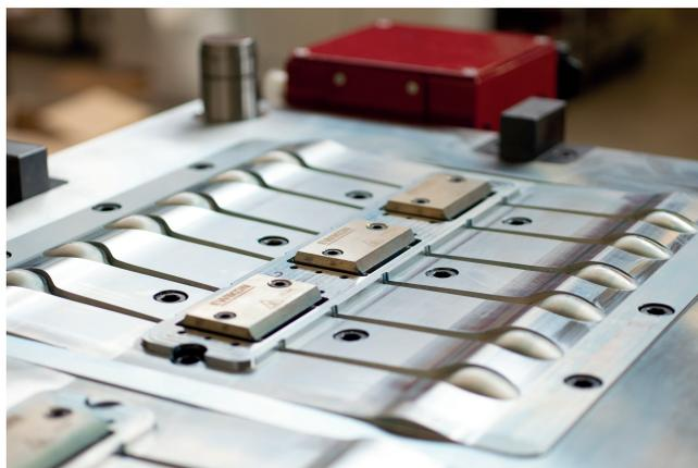
**Bild 2.** Blick auf die heißkanalseitige Formkontur des Werkzeugs für die Fertigung des Eislöffels. Die Artikel werden seitlich angespritzt © Uniform
